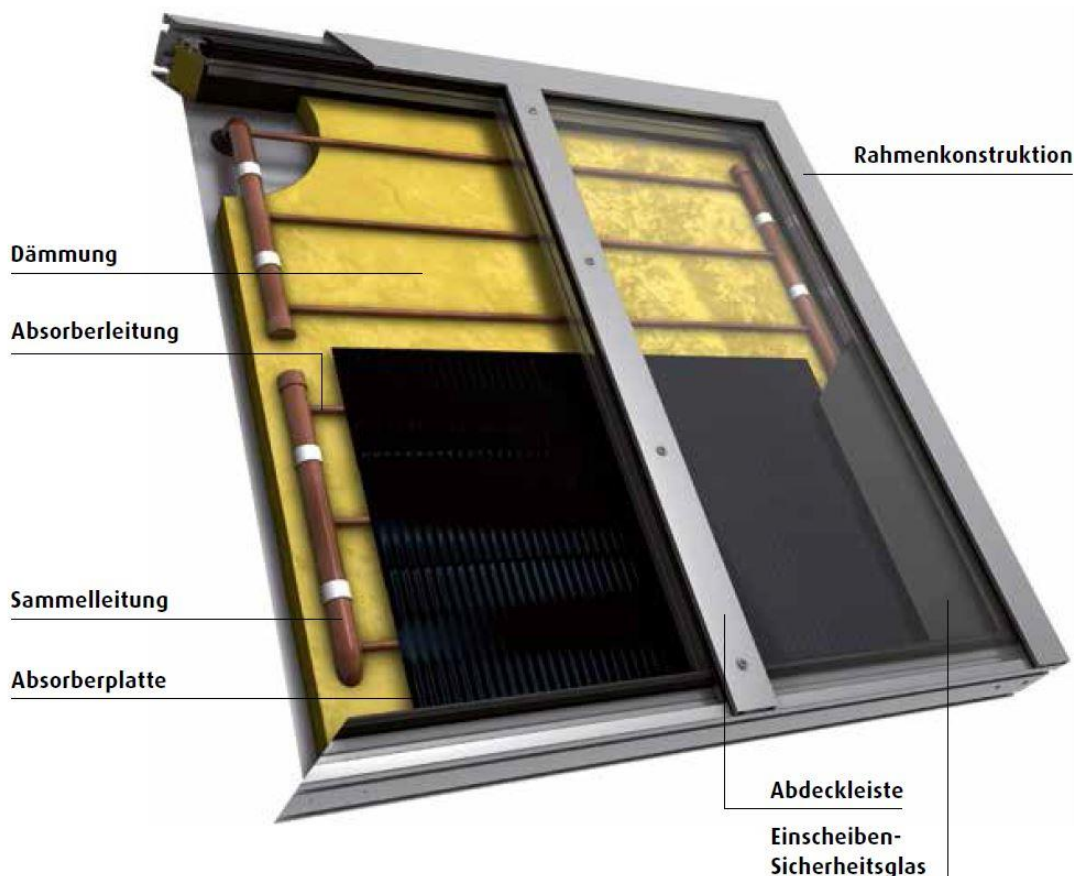
Abbildung zeigt den Aufbau des DOMA FLEX Alu-Grossflächenkollektors
