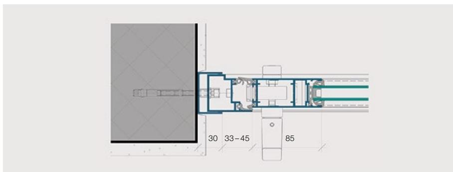
Horizontalschnitt mit Bedienungsflügel, einwärts öffnend
