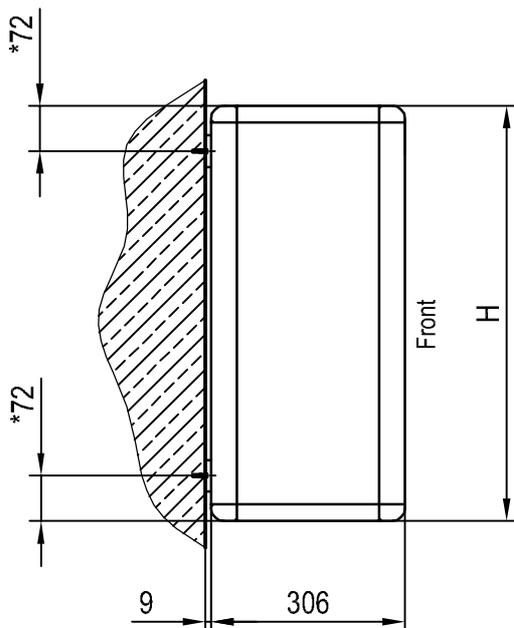
Montage auf Mauer mit Aussenisolation mittels Distanzhülsen
