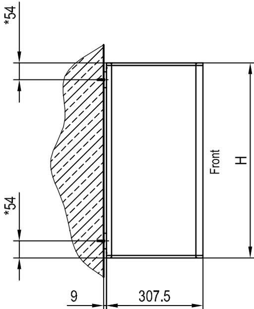
Montage auf Mauer mit Aussenisolation mittels Distanzhülsen
