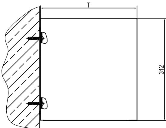
Montage auf Mauer mit Aussenisolation mittels Distanzhülsen
