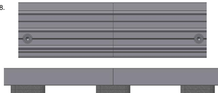
Emboîtement et vissage au niveau de la butée
