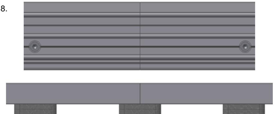
Schiftung und Verschraubung beim Stoss
