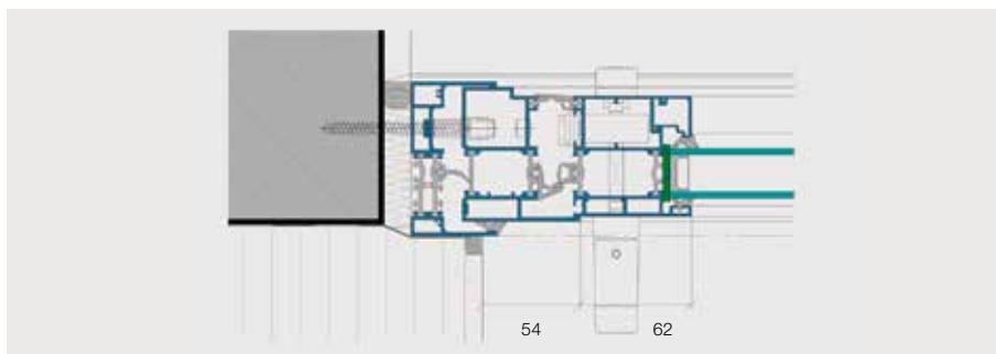
Coupe horizontale avec vantail ouvrant vers l'intérieur
