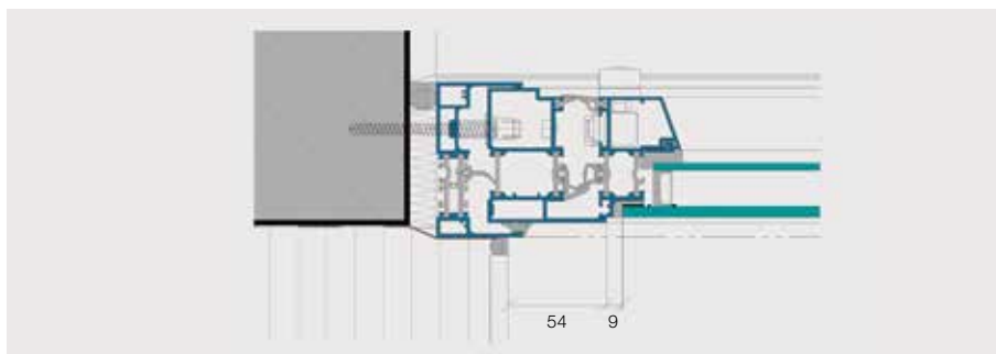
Cadre de côté, avec vantail ouvrant vers l'intérieur
