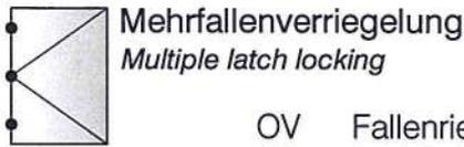
OV Fallenriegelschloss mit Verriegelung nach oben
