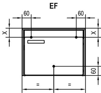
Ausführung EF mit 3 Schrauben befestigt
