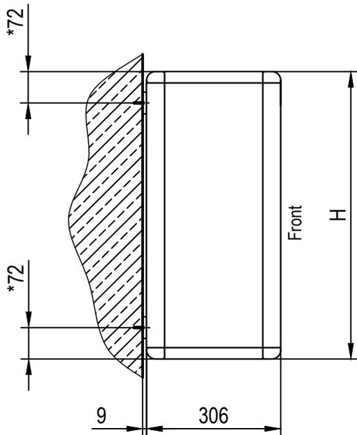
Montage auf Mauer mit Aussenisolation mittels Distanzhülsen
